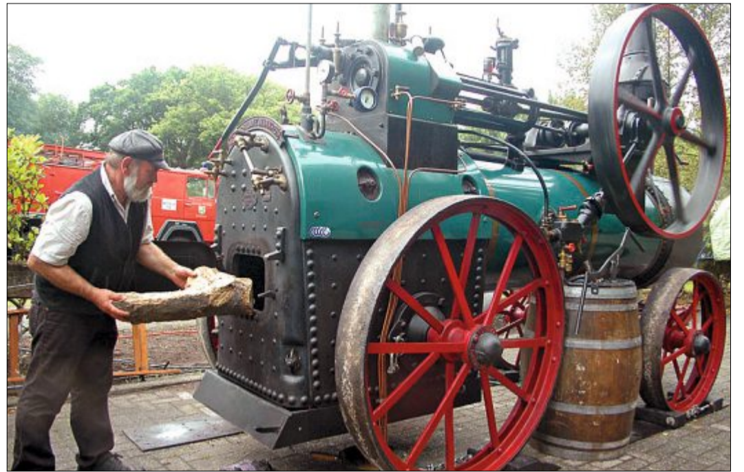
Die Blicke auf sich zog ein Lanz-Lokomobil aus dem Jahr 1912, das Wolfgang Ressel anfuerte. Das Lokomobil dient zum Antrieb einer Geringhoff-Dreschmaschine. FOTOS: HEIN
